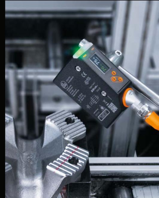
Qualitätskontrolle im Maschinenbau: Der ifm Profiler kontrolliert millimetergenau die Profilhöhe eines Bauteils.
