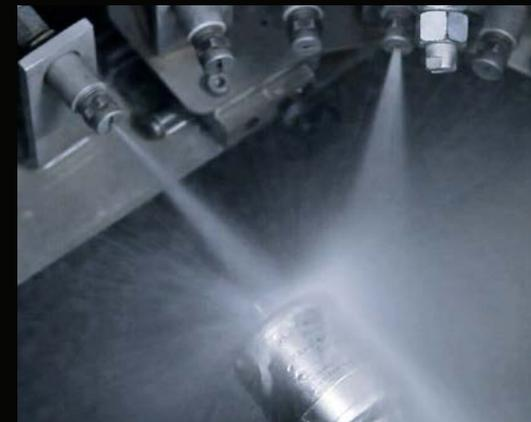
*Dicht unter extremen Bedingungen: Test für die Schutzart IP 69K.*
