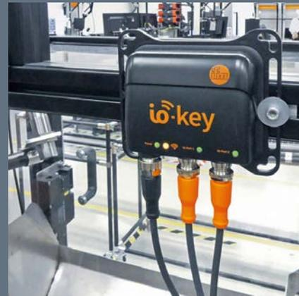
io-key, die Cloud-Verbindung für alle IO-Link-Sensoren.
